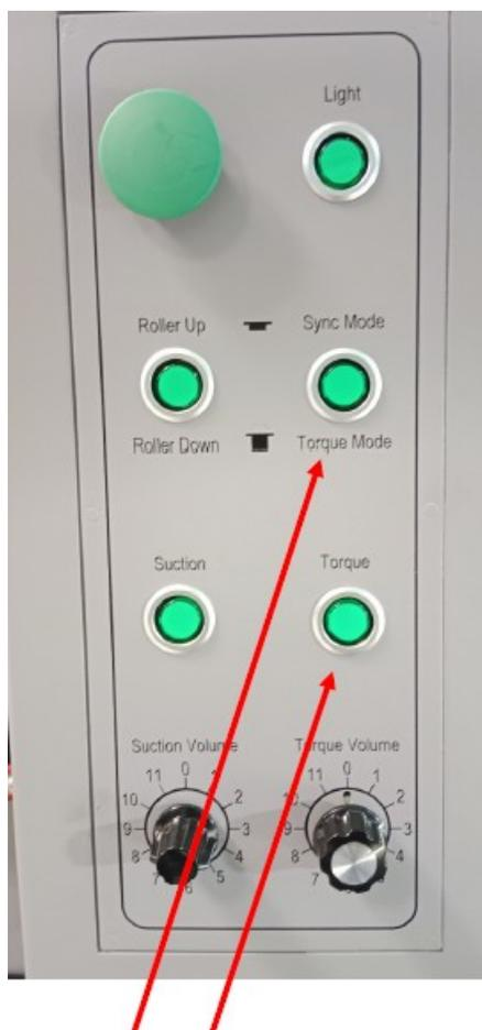
Con tutti e due i pulsanti spenti la macchina è in modalità Sync (i due rulli ruotano alla stessa velocità).
