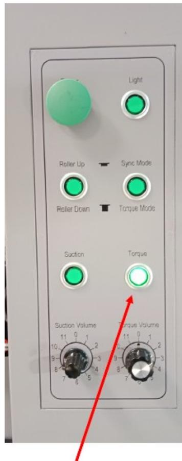
Attivando solo il pulsante Torque, i due rulli ruotano alla stessa velocità, Sync mode.
