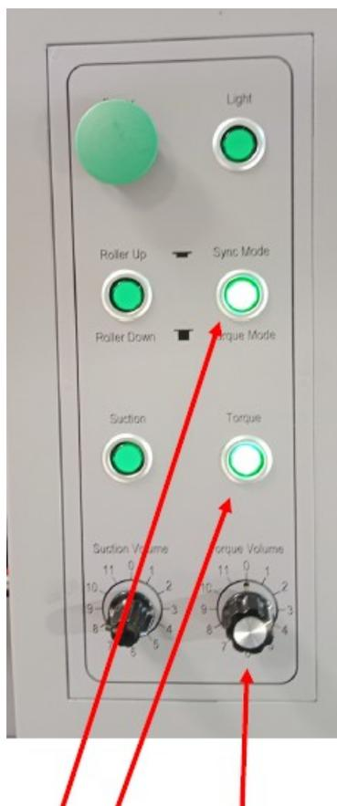
Con tutti e due i pulsanti attivati la macchina è in modalità Torque. Il rullo posteriore avanza in modo regolare, mentre quello anteriore ruota più velocemente in base anche alle impostazioni del Torque Volume.
